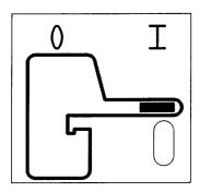
Die Keilriemenscheibe (10) antreiben - die Zapfwelle (11) dreht sich mit!". Den Abschalthebel (9) langsam in Richtung "0" - Stellung bringen.
