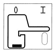
In dieser Stellung muß das Bremsband von der Bremsscheibe leicht abgehoben sein. Dadurch wird ein Festkleben des Bremsbandes an der Bremsscheibe verhindert!
